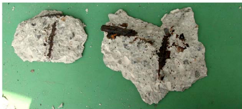
爆裂で落下した 断片の厚さは 約3センチあった
